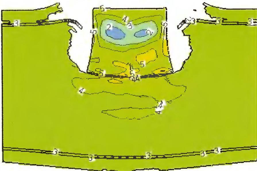
Рис. 5.29. Картина разрушения и поля давлений в бетонной плите, армированной стальными листами, при соударении с ударником со скоростью 500 м/с в момент времени 0,7 мс
