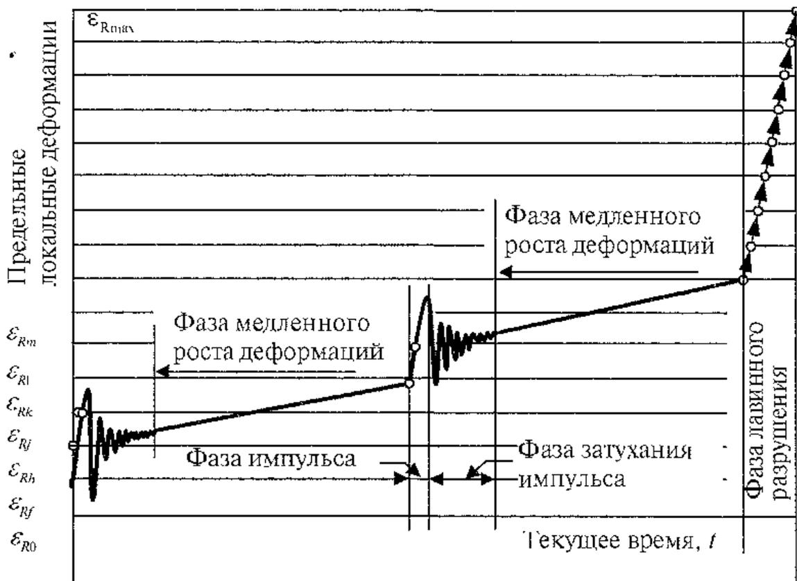
Рис. 2.23. Динамика процесса разрушения в растянутом бетонном элементе при статическом нагружении [50]
